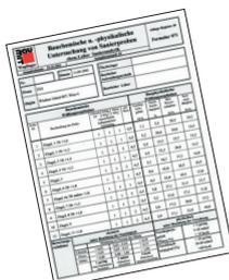
Mediante el preciso análisis de la mampostería (método Darr) se determinan el porcentaje de humedad, el grado de impregnación, la absorción máxima de agua y la capacidad de absorción residual. A partir de ello le entregamos una propuesta de rehabilitación.
