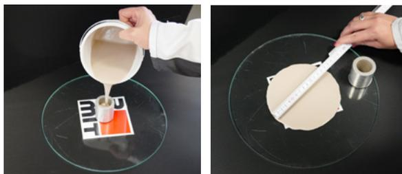
Se lleva a cabo mediante un cilindro de asentamiento con dimensiones: 50 mm x 30 mm (altura x diámetro interior). El cilindro debe ser conforme a EN 12706. El mortero se transfiere al cilindro, que se coloca sobre la placa de vidrio y, seguidamente, se levanta en perpendicular al cristal de la placa y se mantiene durante 15 segundos sobre el asentamiento. El valor correcto para extender el mortero autonivelante no debe superar los 15 cm.
