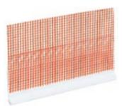
Perfil plástico con malla de fibra de vidrio para la inserción en conexiones de chapa (p.e. terminaciones en borde del tejado) con el fin de conseguir una unión flexible, segura e impermeable entre el revoco y el tejado.
