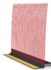
Perfil plástico autoadhesivo de color negro (RAL7016), que admite movimientos en 3 direcciones, con cinta selladora y cinta comprimida, para realizar la unión del SATE con el marco de ventanas y puertas, especialmente para casas de consumo de energía casi nula y casas pasivas. La pestaña que se elimina posteriormente está especialmente diseñada para conseguir la unión con el sistema.
