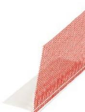
Perfil plástico con malla de fibra de vidrio y goterón para una conexión precisa con el zócalo. El perfil para arranque se inserta entre el aislamiento de la fachada y el zócalo. Indicado para espesores por encima de 16 cm. Máxima diferencia de espesor: 9 cm.
