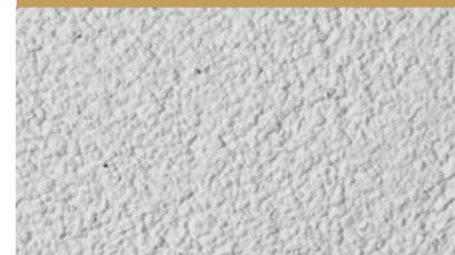
Su formulación única garantiza la mayor eficiencia en cuanto a consumo y rendimiento, dependiendo de la textura y del tamaño del árido. Texturas «Kratz» con un tamaño de grano de 2,0 mm máximo tienen un consumo de 2,9 kg/m<sup>2</sup> mientras que las de 1,5 mm consumen 2,5 kg/m<sup>2</sup>, y las de 3,0 mm necesitarán 3,9 kg/m<sup>2</sup>. Las texturas «Rille» tienen un consumo de 2,6 kg/m<sup>2</sup> con un tamaño de árido de 2,0 mm, y de 3,6 kg/m<sup>2</sup> con 3,00 mm.
