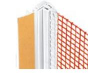
Perfil plástico autoadhesivo, que admite movimientos en 2 direcciones, con cinta selladora y malla de fibra de vidrio para realizar la unión del SATE con el marco de ventanas y puertas. Resistente a la lluvia. Canto con cinta adhesiva integrada para un montaje preciso, incluso después de la instalación de los paneles aislantes. El nuevo diseño ofrece una aplicación aún más segura.
