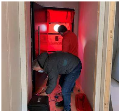
Figura 14. Ensayo Blower Door (Fuente: Medgón PassivHaus)
